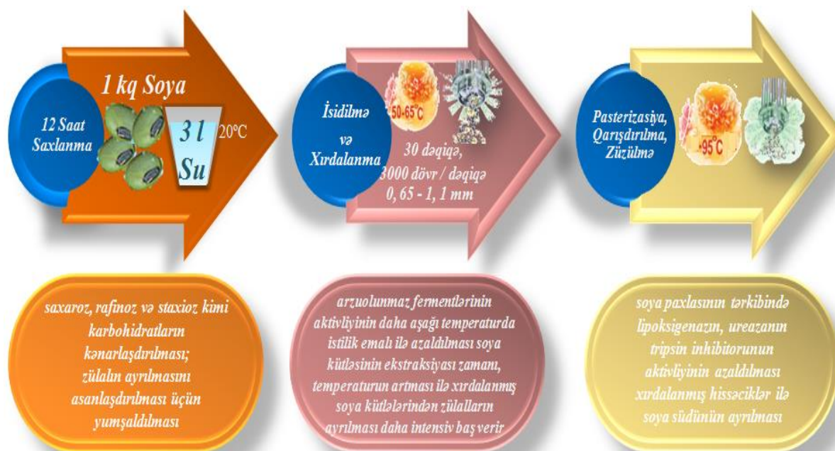
Şəkil 6. Soya südü istehsalı texnologiyası
