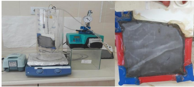
Şekil 1. Vakum ile çalışan reaktör düzeneği ve çalışmada kullanılan paslanmaz çelik ağa sahip modül.
