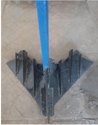
Şəkil 4. “Aqromexanika” ETİ-nun emalatxanasında yeni yaradılan kultivator-yastıkəsicinin pəncələrinin görünüşləri.
