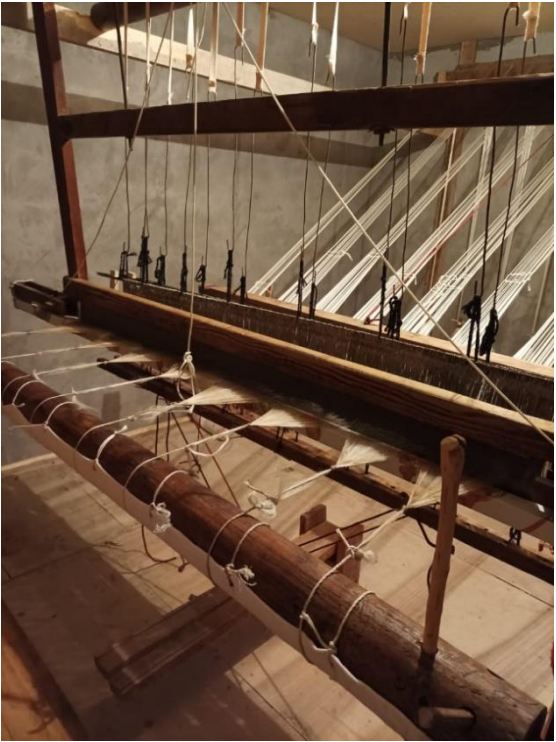
Şəkil 1. Ənənəvi dəzgahda əriş saplarının yüklənmə prosesi
