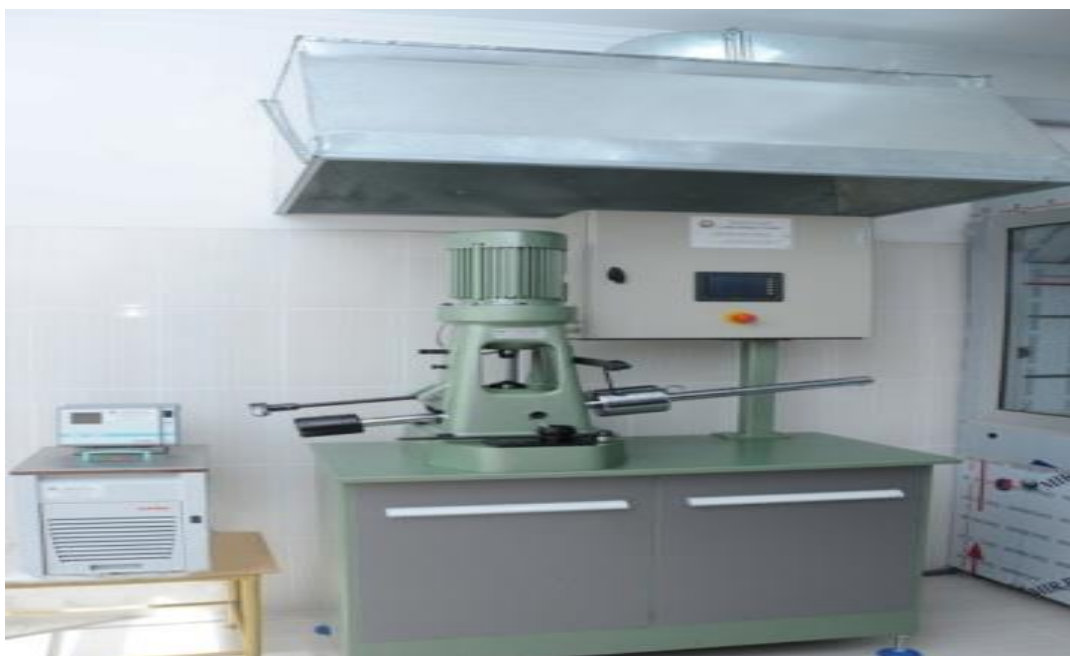
Şəkil. Dördkürəli sürtünmə maşını (ASTM D2266, D2596, D2783) (Petrotest, Almaniya)
