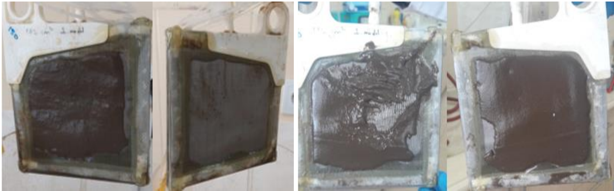
Şekil 4. DMBR’de oluşan kek tabakası (solda ilk iki fotoğraf), YÇ-DMR’de oluşan kek tabakası (sağdaki iki fotoğraf). DMBR’de modülün iki yüzünde, ya daha kalın ya da daha ince kek tabakası oluşturduğu, YÇ-DMR’de ise modülün her iki yüzünde ince ve düzgün kek tabakası olduğu gözlenmiştir.
