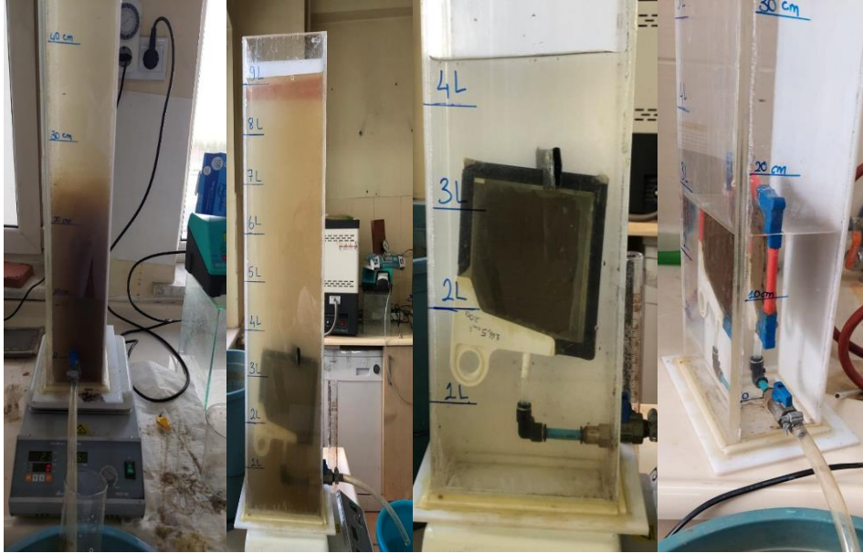
Şekil 3. GD membran reaktörde filtrasyon öncesi ve filtrasyon sonrası reaktörün görüntüleri. 1. Resimde oğun bir çamur ve bulanık bir su görülürken, 2. Resimde reaktör içindeki modül net olarak görülebilmektedir. 3. ve 4. Resimde ise tabakanın tamamen modül üzerinde kaplandığı ve reaktördeki suyun berraklaştığı ortaya çıkmıştır.
